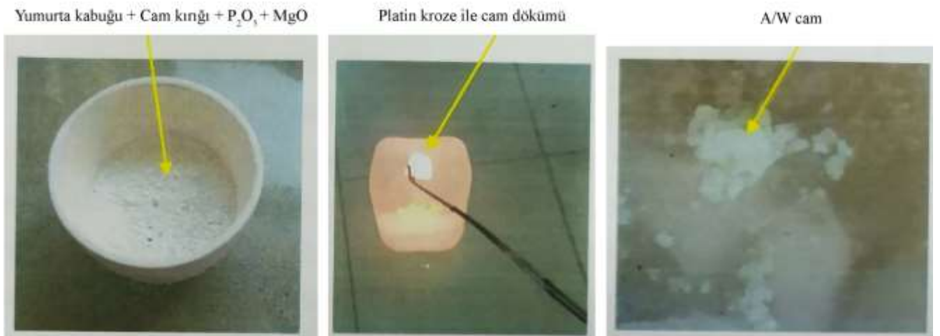
Şekil 4: Toz karışımı, platin kroze ile cam dökümü ve döküm sonrası A/W cam görüntüsü
