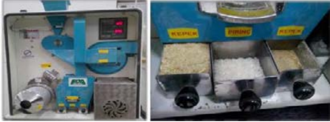
Şekil 1. Pirinç ve kepek ayırma makinesi
