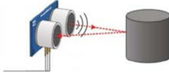
Şekil 4. Ultrasonik sensör çalışma prensibi [10]
